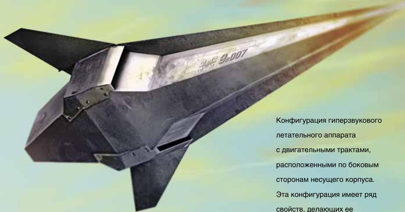
Конфигурация гиперзвукового летательного аппарата с двигательными трактами, расположенными по боковым сторонам несущего корпуса. Эта конфигурация имеет ряд свойств, делающих ее в некоторых случаях альтернативной традиционной
