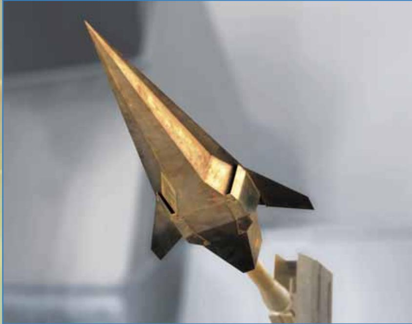
Новая конфигурация гиперзвуковых летательных аппаратов. Двигательный модуль с воздухозаборником также расположен под нижней поверхностью несущего корпуса.
